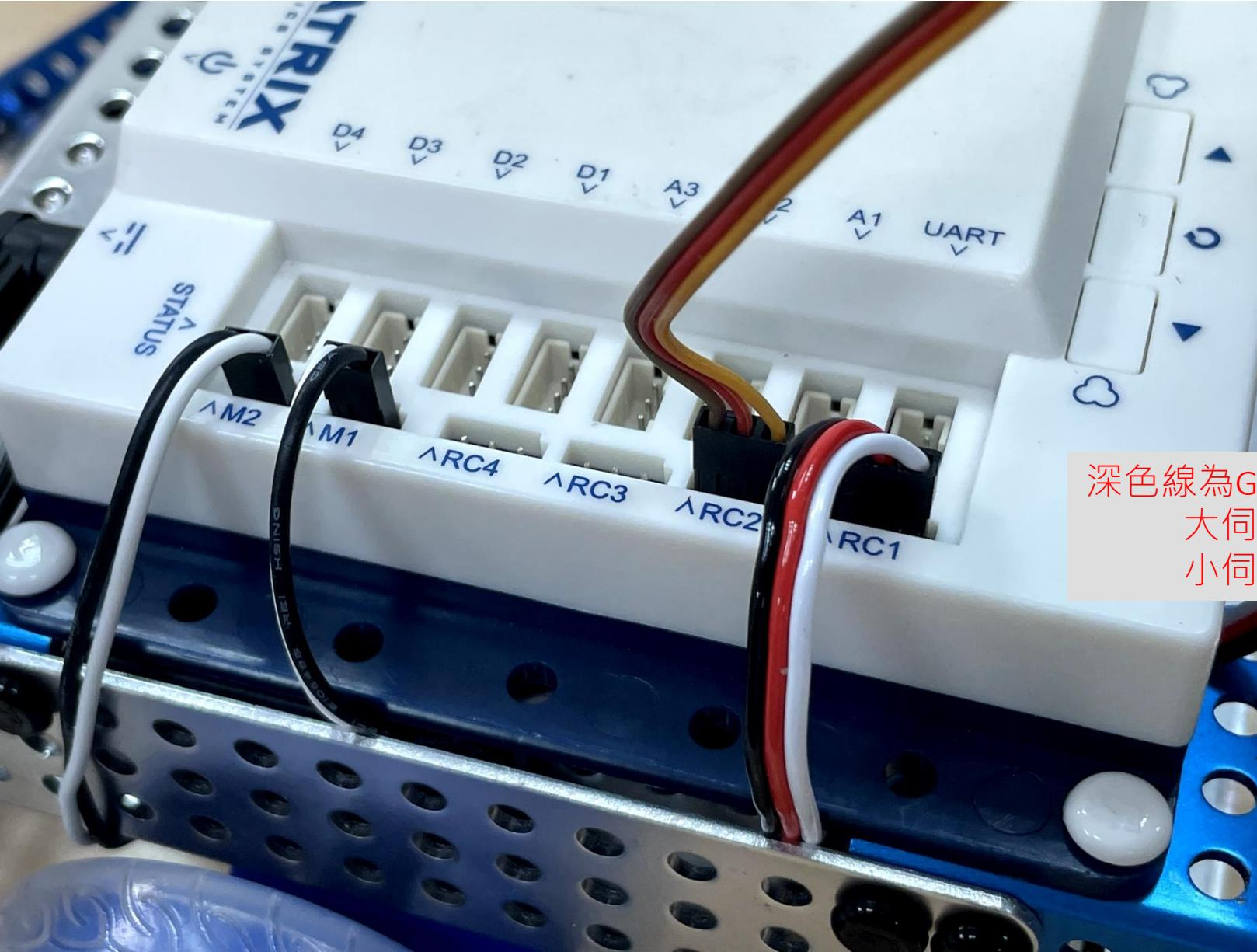
深色線為GND；GND靠R旁邊的^大伺服馬達接在RC1
